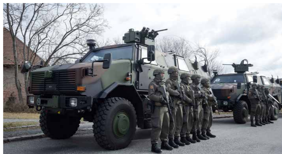
Der „Dingo“ 2 ermöglicht den sicheren Transport von Soldaten unter Beschuss- und Minenbedrohung und kann u. a. im Transportflugzeug vom Typ C-130 „Hercules“ verladen werden.
